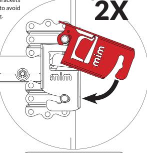
POSITIONING OF CLIP FOR **STRAIGHT JUMP**
